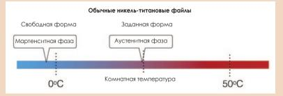
Рис. 5, а. Суперэластичные никель-титановые файлы с памятью формы произвели революцию в эндодонтии. Несмотря на все свои преимущества, эти инструменты были подвержены поломкам вследствие усталости металла при циклических нагрузках и его разрушения при кручении.
