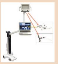
Рис. 2. Оптический датчик отслеживает положение маркеров Jaw-Tracker и Drill-Tag, метчика
