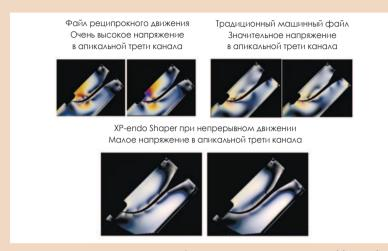
Puc. 8, а. Эксперименты с использованием моделей, выполненных из пластмассы с эффектом фотоупругости, позволяют проанализировать нагрузки, возникающие в сложных условиях. Как показывают эти изображения, инструмент XP-endo Shaper создает в апикальной трети канала наименьшее напряжение.
